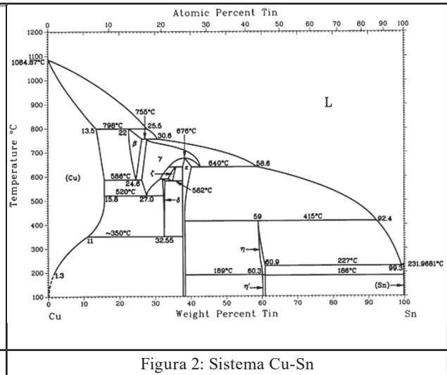
Figura 2: Sistema Cu-Sn
